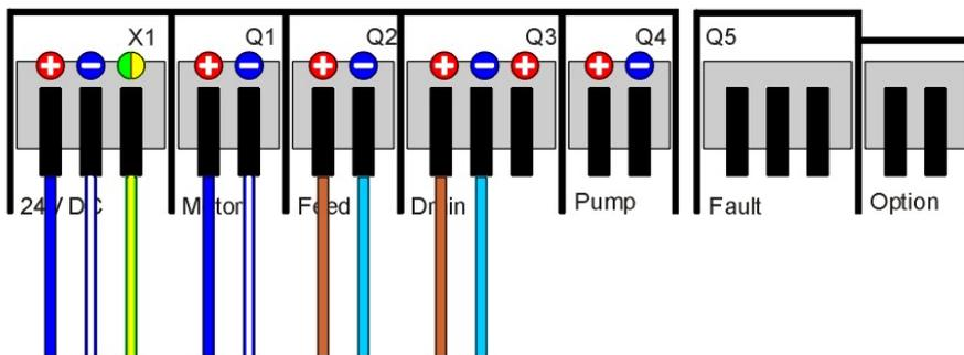
Abbildung 13: Ausgänge verdrahten
