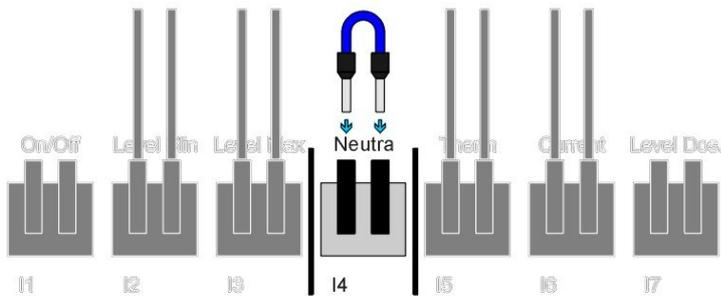
Wird keine Neutralisationsanlage verbunden, muss eine Drahtbrücke eingelegt werden.
