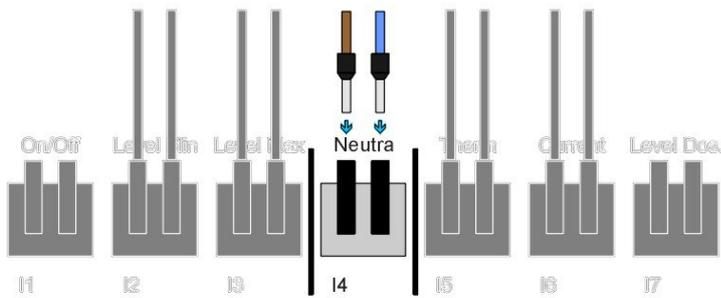
Wird der Eingang durch einen geschlossenen Kontakt aktiviert, wird der automatische Waschflüssigkeitswechsel freigegeben. Andernfalls erkennt der Abluftwäscher, dass die Neutralisationsanlage derzeit keine Flüssigkeit aufnehmen kann, und hält die Waschflüssigkeit zurück.
