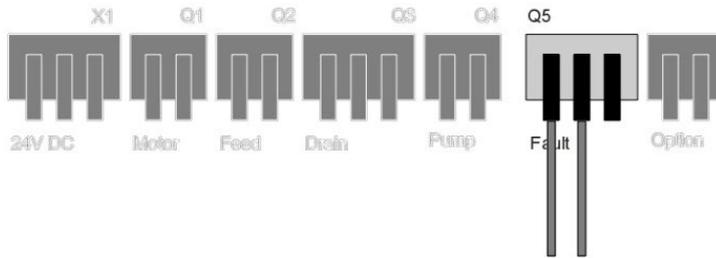
Kontakt im Gutzustand geschlossen, im Fehlerfall geöffnet
