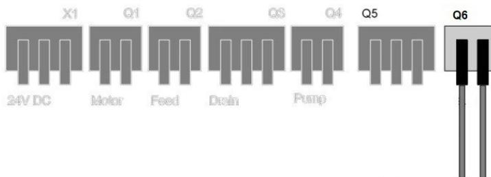
Kontakt ist geöffnet, so lange der Abluftwäscher aus ist, und wird eingeschaltet, wenn der Abluftwäscher in Betrieb ist.
