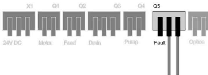
Kontakt im Gutzustand geöffnet, im Fehlerfall geschlossen
