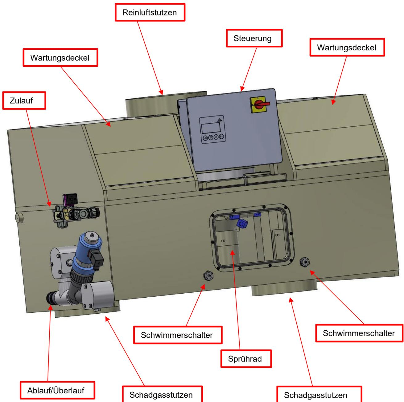
Abbildung 1: Aufbau Abluftwäscher
